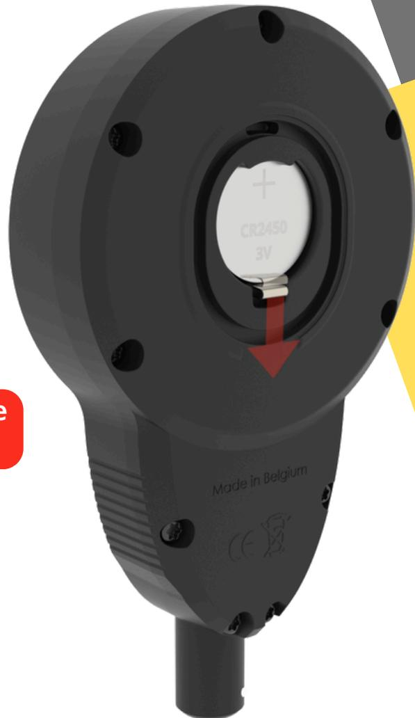
**Legen Sie die neue Batterie mit dem Pluspol nach oben ein und schieben Sie sie in den TJr, bis die Verriegelung einrastet.**
